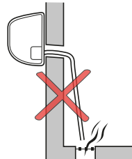
Dräneringsröret ligger för nära en illaluktande källa
